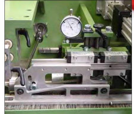
Abb. 1: Haarige Angelegenheit: Drylin-Gleitlager sind unempfindlich gegenüber Staub.
