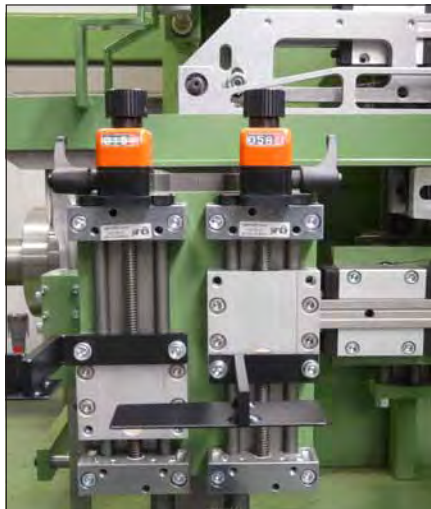
Abb. 4: Bei der Formverstellung bewähren sich Lineargleitlager aus der Serie Drylin T in Kombination mit Spindelhubtischen der Baugröße SLW. Gut zu sehen: Die Borsten.
