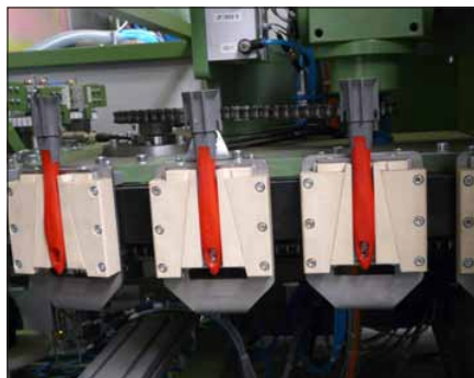
Abb. 6: „Eigenbau“ aus Iglidur-Halbzeugen: Die Greifer der Rundtakt-Maschine FP 900 B.
