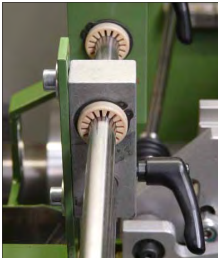
Abb. 3: Zur Führung von Zylindern setzt Wöhler häufig Linear-Gleitlagerbuchsen der Baureihen RJM/RJMP ein.
